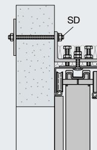
Uniquement avec un linteau en béton armé selon certification statique. Le linteau doit être exécuté au-delà de la baie de porte conformément à la longueur du rail de guidage.
