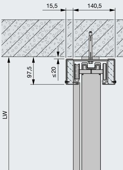
Montage suspendu au plafond (longueur de tige filetée jusqu'à max. 200 mm)
