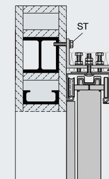
Charpentes métalliques avec bardage, classe minimale de résistance au feu F90, désignation abrégée F90-A selon la norme DIN 4102-4.
